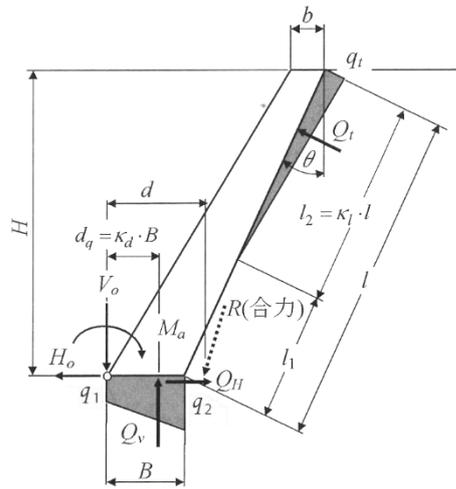
図 3-39 地盤反力係数法（簡便法）
