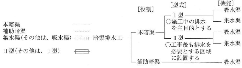
図 3-69 地下水排水工の配置
