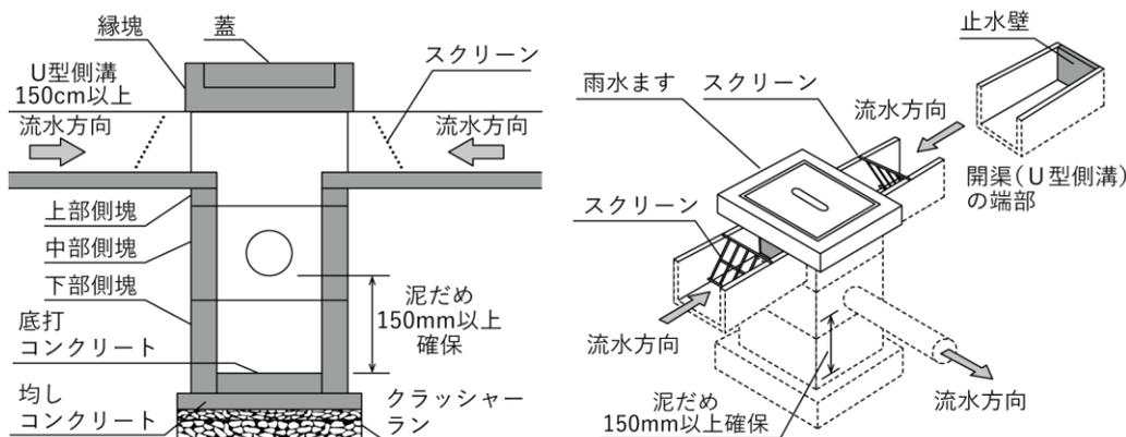
図 3-61 排水工の標準構造図
