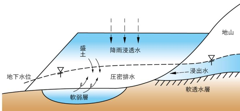
図 3-67 地下水の各構成成分
