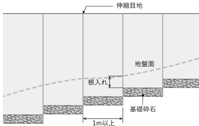
図 3-14 斜面に沿って設置する擁壁
