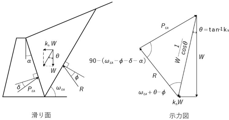
図 3-34 地震時主働土圧の考え方
