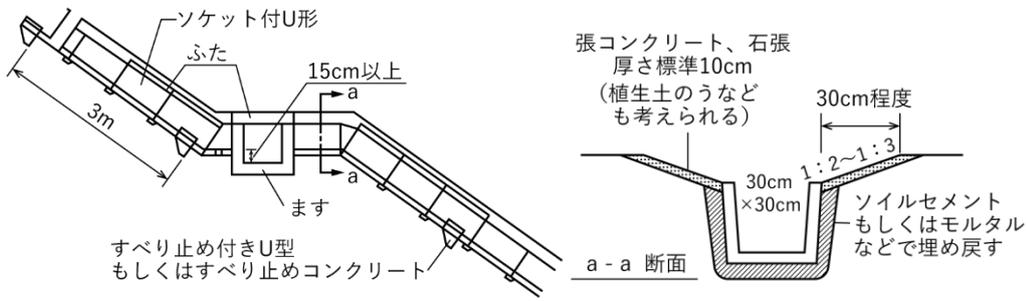
図 3-66 U型による縦排水工の構造図
