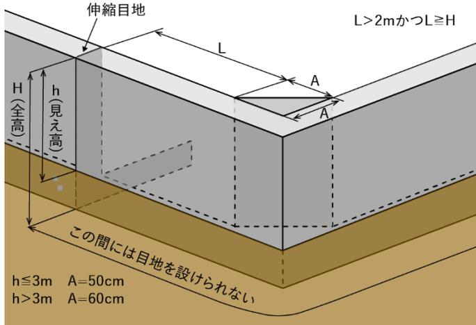
図 3-23 鉄筋コンクリート造擁壁等の伸縮目地及び隅角部の補強位置①
