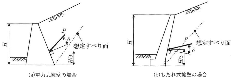
図 3-30 土圧作用面（重力式擁壁等）
