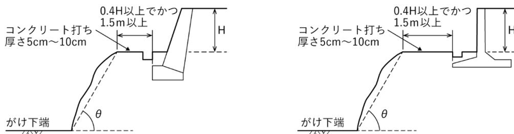
図 3-15 斜面の擁壁の構造
