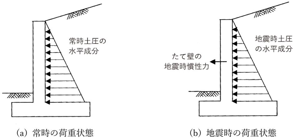
図 3-40 豎壁の断面計算における荷重状態
