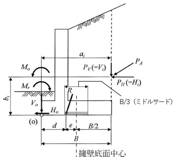
図 3-37 合力作用位置の求め方
