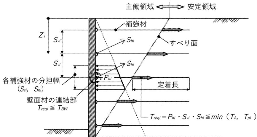
図 3-53 補強材に作用する引張力の考え方[引用]道路土工-擁壁工指針（(社)日本道路協会、平成24年7月）、一部加工
